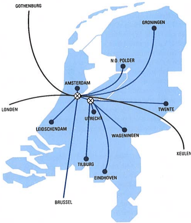
◀ Afb. 5 Voorlopige netwerkconfiguratie voor de nationale ATM-pilot. Alle verbindingen naar klantlocaties zijn gebaseerd op 34 Mbit/s huurlijnen.
